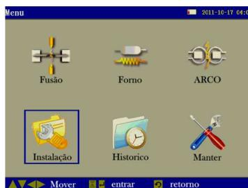
O display a cores de 5,1", permite ao operador visualizar com toda a clareza as fibras a fundir. Através das duas câmaras internas de alta resolução, o utilizador pode ter uma imagem ampliada até 300 vezes e visualizar os eixos X e Y simultaneamente de modo a facilitar toda a operação.
